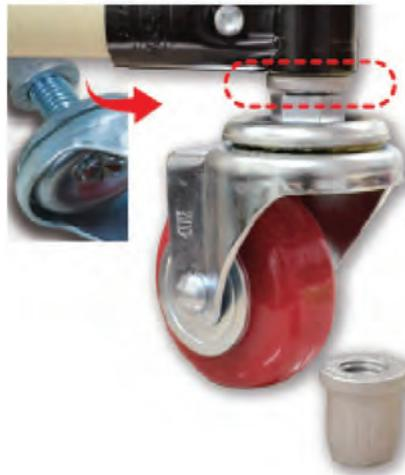
Die Befestigung der Laufrollen an der Platte wird für höhere Tragfähigkeiten verwendet. Die maximale Tragfähigkeit wird immer durch die dynamische Tragfähigkeit der Rolle angegeben. Die Befestigung erfolgt mittels Schrauben und Verbindern MT-5109 oder Eckelementen MT-5139. Das MT-5139-Eckelement sorgt außerdem für eine höhere Stabilität der Regale. Das Anzugsdrehmoment der Schrauben beträgt in diesem Fall 12 Nm.
